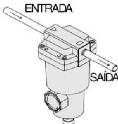
**1** - Verifique o sentido do caudal de ar comprimido e a " ▶ " marca que indica o lado de entrada do produto antes de efetuar a ligação. Não pode ser utilizado com o sentido invertido.
